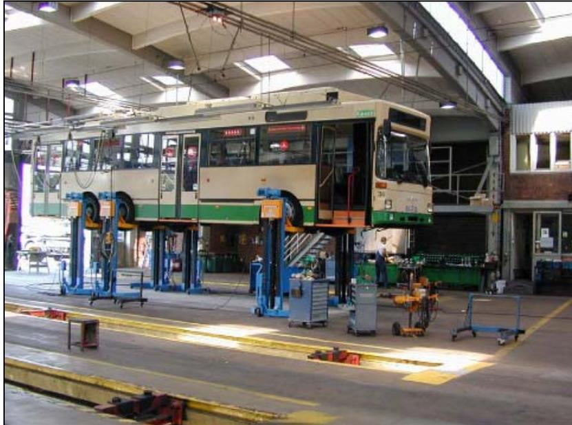
Abb. 18: Gemeinsame Werkstatt für Diesel- und Obusse mit einem Dacharbeitsstand zur Wartung der Aufbauten [45]
