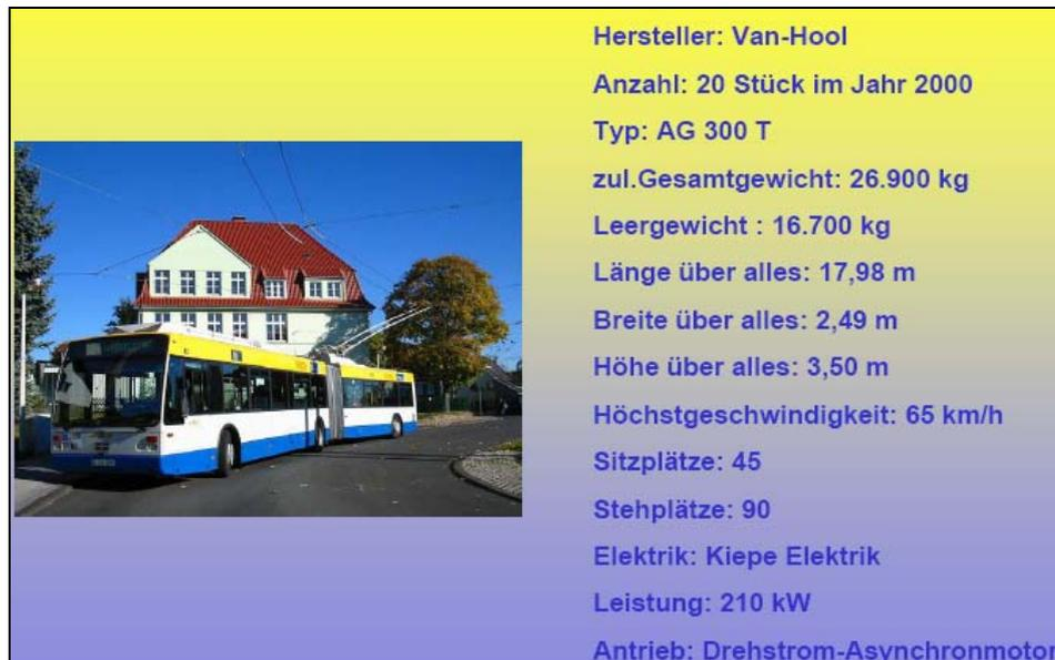
Abb. 16: Der Niederflur-Gelenk-Trolley AG 300T in Solingen [43]
