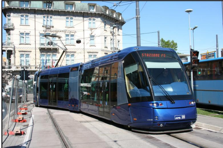
Abb. 8: Das System Translohr als spurgeführte gummbereifte Straßen-/ Stadtbahn [23]
