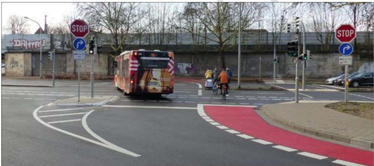
Abbildung 19: Beispiel zur Busbeschleunigung an der Kreuzung Bramscher Straße/Hansastraße in Osnabrück
