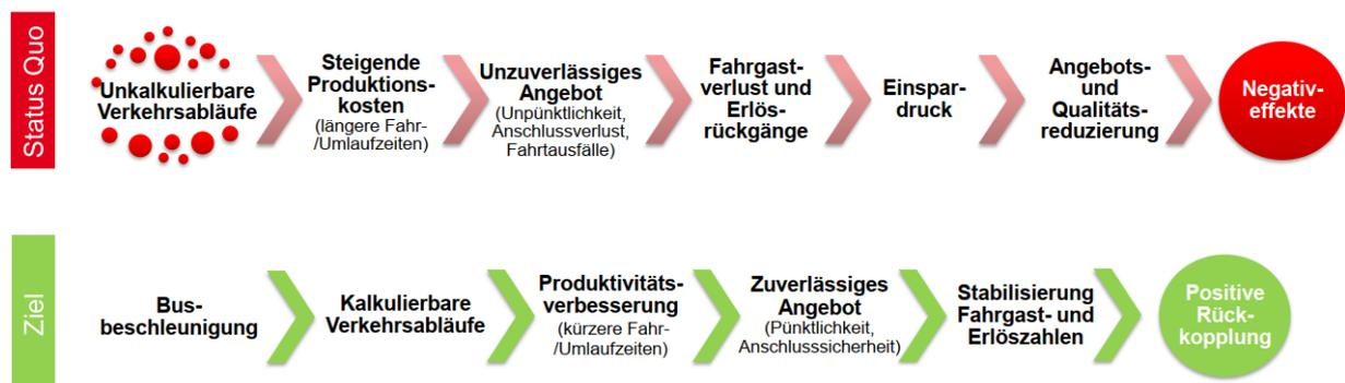
Abbildung 17: Wirkungsverlauf Busbeschleunigung (Quelle: eigene Darstellung)
