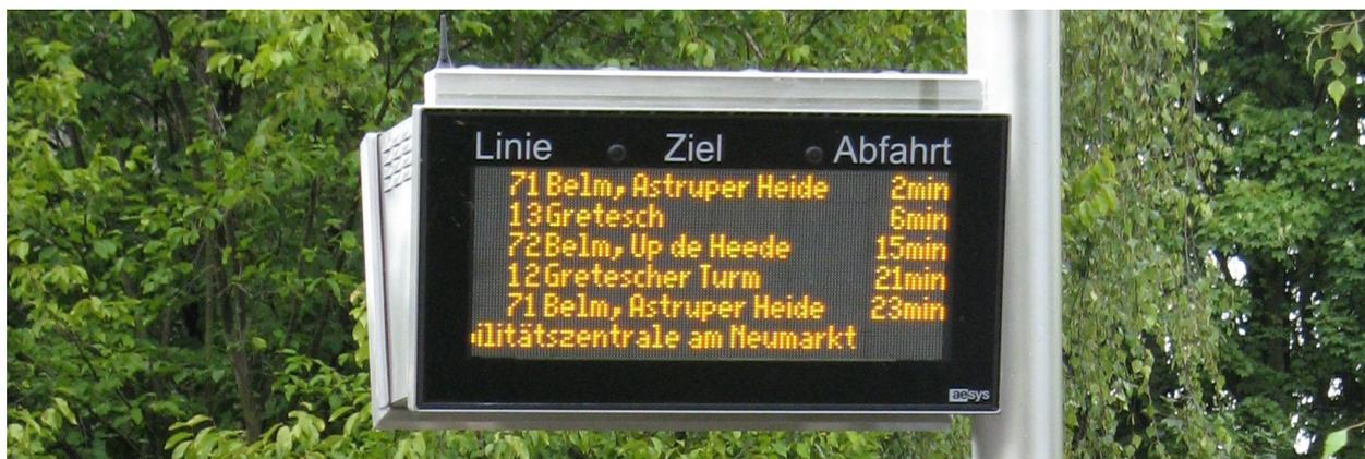
Technische Mängel sowie Unzulänglichkeiten in der Ausgabe freier Texte führten dazu, dass die Stadtwerke beim weiteren Ausbau der dynamischen Fahrgastinformation ab dem Jahr 2006 auf eine neue Generation von Geräten mit **mehrzeiligen LED-Anzeigen und der Möglichkeit zu Fließtexten** setzte.
